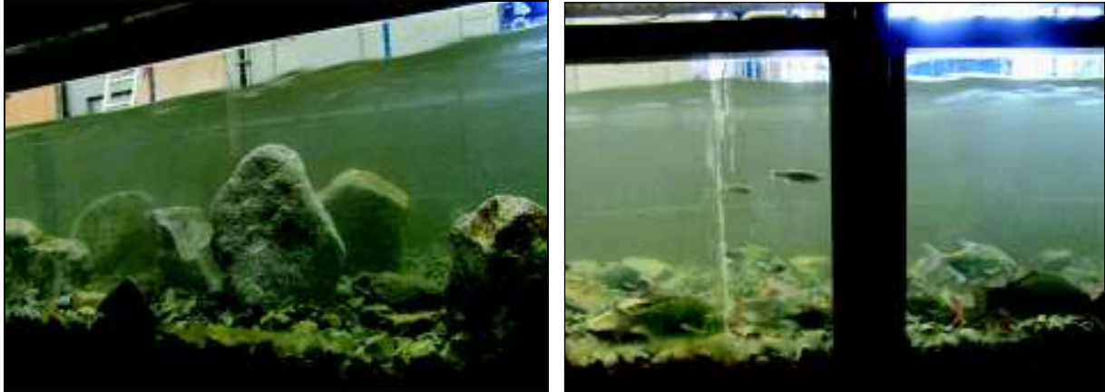
Abbildung 41 und Abbildung 42: Zu hohe Rauigkeiten behindern durch Wirbelbildung schwimmschwächere Arten beim Aufstieg (links); bevorzugt werden Bereiche mittlerer Rauigkeit mit wenigen ca. 15 cm aus der Sohle ragenden Einzelsteinen (ADAM et al. 2009); (Seite „Ethohydraulik“. In: Wikipedia, Die freie Enzyklopädie. Bearbeitungsstand: 17. August 2009; abgerufen: 4. Oktober 2009).
