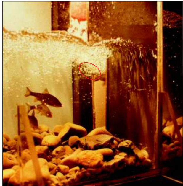
Abbildung 34: Standort von Rotaugen im Strömungsschatten des Umlenkblockes, von hier starten sie das Durchschwimmen des Schlitzes (GEBLER 1991); Bereich der höchsten FG rot gekennzeichnet, deutlich zu erkennen die Wirkung der Turbulenz anhand der Körperhaltung, raue Sohle damals noch gerundeter Schotter.
