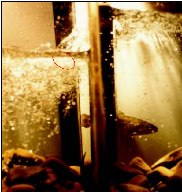
Abbildung 33: Schlitzströmung mit aufsteigender Bachforelle (GEBLER 1991); Bereich der höchsten FG ist rot gekennzeichnet, raue Sohle damals noch anhand von gerundetem Schotter eingebracht.
